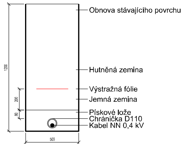
Uložení kabelu VN ve volném terénu (bez možnosti mech. poškození)
